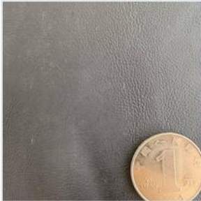
2117 底布 6357 压纹 T-197 厚度 0.45mm 克重 245g
