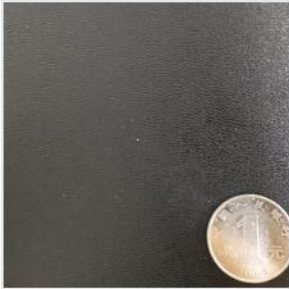
Q6124 底布 014Z 压纹 T-137 厚度 1.6mm 克重 940g
